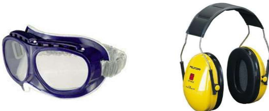
Obrázek 3. Vlevo uzavřené brýle s nepřímou a částečně přímou ventilací, určeny k ochraně očí proti prachu. Vhodné k obrábění tvrdých materiálů. Vpravo mušlový chránič sluchu Peltor pro středně hlučná prostředí (do 27dB) s náhlavním páskem ( www.manutan.cz/ochranne-pracovni-pomucky_c_Main12051841.html?finalCatString=8600827866532001558%3B8600827866532001559&viewSize=30&identifier=Main1205184 )
