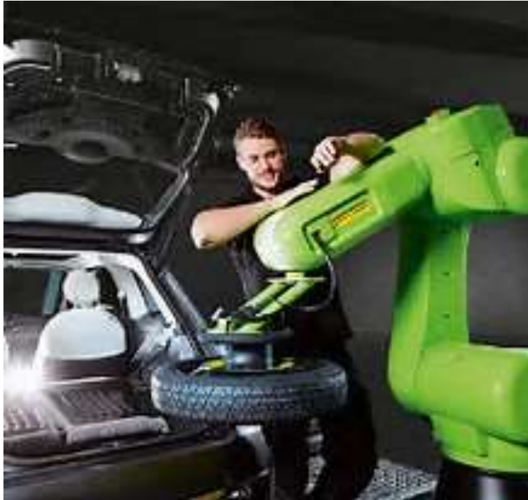
Obrázek 2. Kolaborativní robot FANUC CR-35iA ( https://factoryautomation.cz/co-je-to-kolaborativni-robot-5-veci-ktete-byste-o-nem-meli-vedet/[online] ). 2017. [cit 2017 – 10 - 19])
